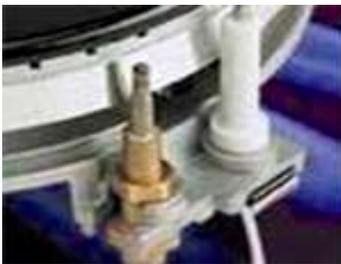
**Sistema de seguridad TERMOPAR**, este sistema permite cortar el paso del gas en caso de apagado accidental de la llama. Una pequeña válvula detecta la ausencia de llama y corta el paso del gas, para evitar algún accidente.
